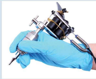
Un dermographe est composé d'aiguilles attachées à une barre avec un canon électrique. Lorsqu'il est enclenché, les pointes se déplacent rapidement de haut en bas et l'action des aiguilles permet l'insertion de l'encre.
